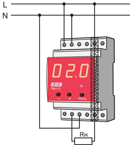
Такая схема подключения допускается при мощности потребляемой нагрузкой до 2кВА.
